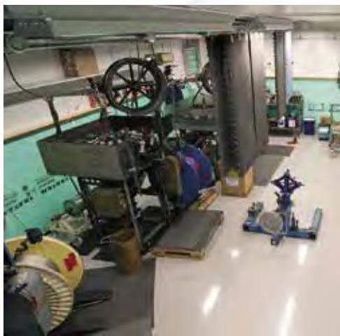
Da Bild zeigt eine Verseilungsmaschine zur Fertigung des SUPRA PLY.
