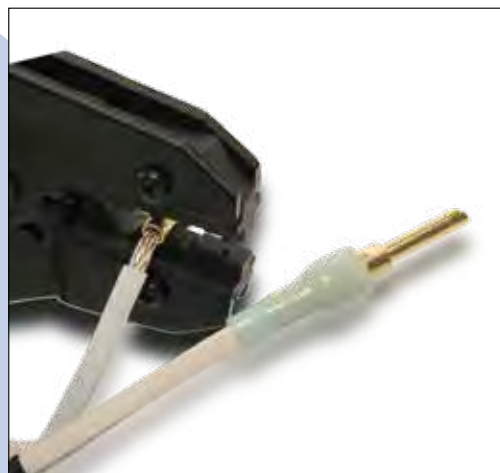
Jede im Werk gemachte Crimpverbindung wird mit speziellen Werkzeugen hergestellt. Das Bild zeigt den Vorgang mit einer Crimpzange.
