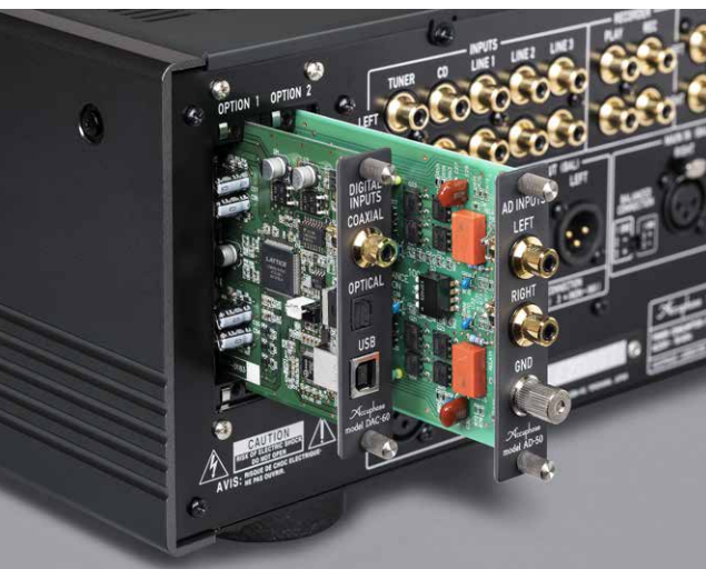
Wie üblich bei den größeren Vor- und Vollverstärkern von Accuphase gibt es zwei Schächte für optionale Phono- (r.) und D/A-Wandler-Module.
