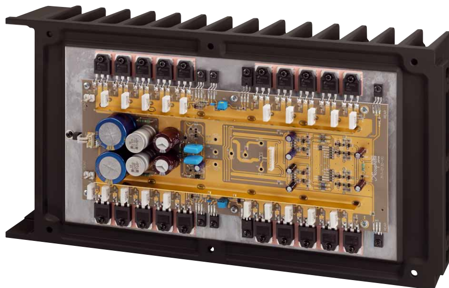
Zwei dieser Module arbeiten parallel und bilden einen Kanal der A-300
