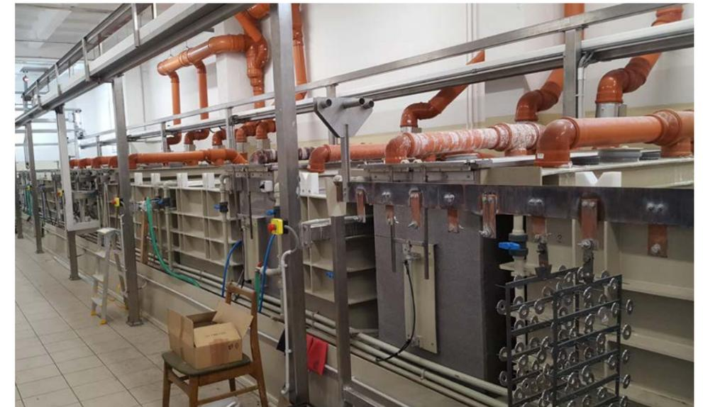
Die abschließende Fertigungsstufe für Aluminiumteile ist die silberfarbene oder schwarze Eloxierung. Sie erfolgt auf einer eigens von CANOR entworfenen und gebauten halb-automatischen Linie, da nur so die hausintern auferlegten spezifischen Anforderungen wie eine maximale Qualität der eloxierten Oberfläche, eine eindeutige Wiederholbarkeit der Farbtöne und eine optimale Haltbarkeit garantiert werden können.
