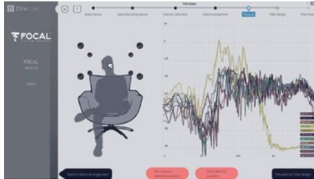
Quando terminar as 9 ou 16 medições, clique no botão "Proceed to filter design" (Avançar para a configuração do filtro).
