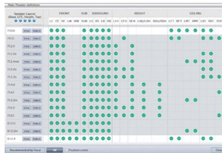
定义根据通道数按以下顺序排列。底层。LFE层。高层。顶层。例如，9.1.0.6模式配置9组耳级扬声器、1个低音通道、0个高层扬声器（仅适用于Auro3D布局）和6组吸顶扬声器。对于每种模式定义，可使用矩阵查看该布局与3个编解码器中分别的兼容性，以及哪些可能的扬声器位置被占用。您还可以点击“VIEW (查看)”以查看房间中的可视化布局，以便减少歧义。
