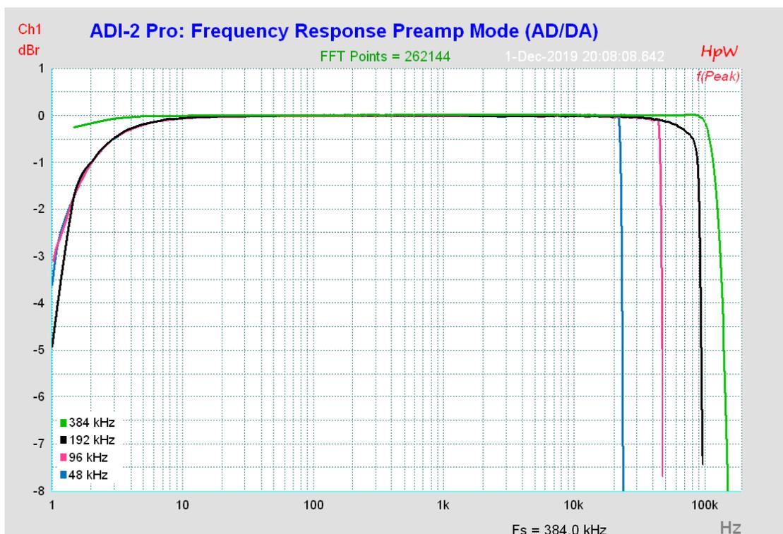
Hinweis: 44,1 kHz bis 192 kHz gemessen mit Filter Sharp für AD und DA.
