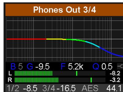
Ein inverses Filter ergibt sich nach Selektion von Band 5 mit Filtertyp Shelf, Q auf 0,5, Frequenz auf 5,2 kHz, und Gain auf -9,5 dB. Eine Pre-emphasis entsteht mit den gleichen Einstellungen, aber Gain auf +9,5 dB.
