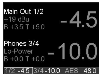
Um trotz fehlender Pegelanzeige eine Übersteuerung durch Volume, PEQ oder B/T erkennen zu können, sind die beiden großen Volume-Zahlen mit der Over-Erkennung der beiden analogen Ausgänge gekoppelt. Sie wechseln ihre Farbe bei Übersteuerung zu rot.
