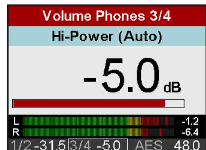
Nach korrekter Lautstärkeeinstellung, mit der das Level Meter unterhalb des roten Bereichs bleibt, kann sich der Anwender nun 100% sicher sein, dass der ADI-2 Pro absolut verzerrungsfrei arbeitet, selbst in den extremsten Anwendungsfällen.
