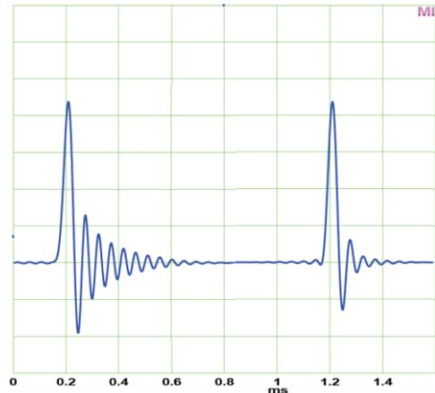
SD Sharp und SD Slow sind IIR Filter, die hauptsächlich Nachschwingen erzeugen, aber nicht phasenlinear sind. Der Vorteil von IIR liegt in der extrem kurzen Latenz von wenigen Samples, was besonders nützlich beim Monitoring im Studio ist.
