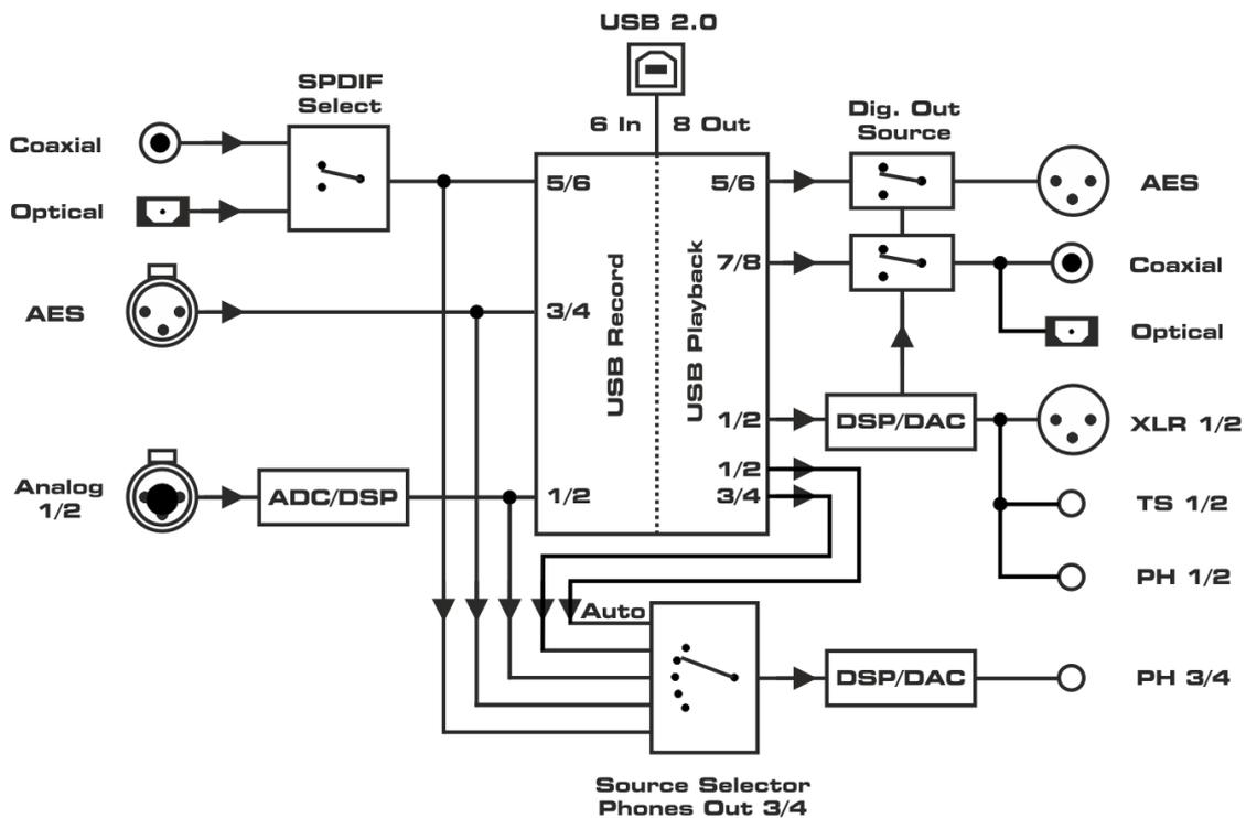
Die Option *Digital Out Source - Main Out* (SETUP – Options – Device Mode / DSD) sendet das prozessierte Signal Main Out 1/2 an die digitalen Ausgänge AES, SPDIF und ADAT, z.B. zum Anschluss aktiver Monitore mit digitalen Eingängen. Die Wiedergabekanäle 5/6 und 7/8 sind dann nicht mehr nutzbar.
