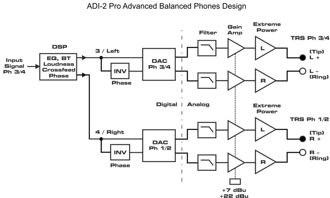
Der ADI-2 Pro besitzt zwei DACs und einen leistungsfähigen DSP. Diese Zutaten erlauben eine stark verbesserte Version mit mehreren Vorteilen:
