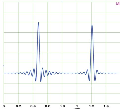
SD Slow und Slow arbeiten optimal bei 88,2/96 kHz, da dann die Absenkung außerhalb des Hörbereichs beginnt, bei fast perfekter Impulsantwort – sowohl durch das Filter, als auch durch die doppelte Samplefrequenz.
