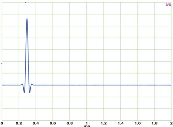
Die obigen Bilder zeigen das analoge Ausgangssignal der Filter des DAC, angeregt von einem digitalen Single Sample Impuls bei 44,1 kHz Samplefrequenz. Slow hat zwar die optimalste Antwort, verliert aber schon bei 15 kHz circa 1,2 dB, siehe Kapitel 34.14. Die beiden Short Delay sind IIR-Filter, die anderen beiden FIR. FIR ist phasenlinear über den Frequenzgang.
