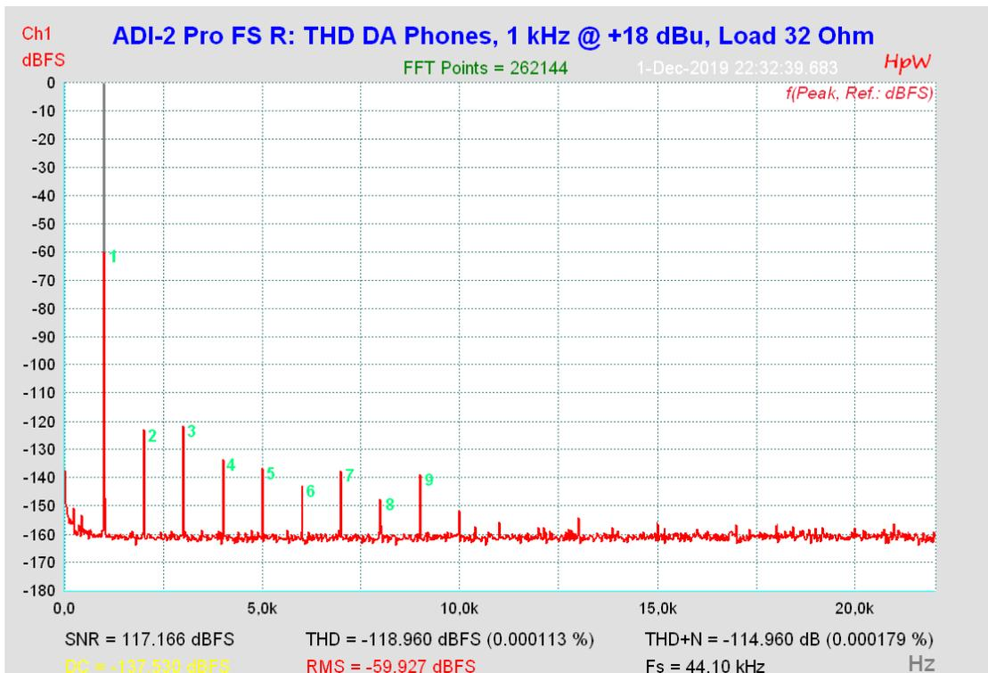
\*\* Gemessen mit aktivem Notch-Filter über den ADC des ADI-2 Pro FS. +18 dBu Ausgangspegel an 32 Ohm entsprechen 1,2 W (pro Kanal)
