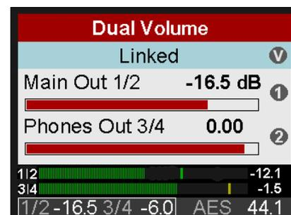
Die beiden Ausgänge lassen sich im Dual Volume Screen jeweils durch Druck auf Encoder 1 (B) und Encoder 2 (T) stumm schalten.
