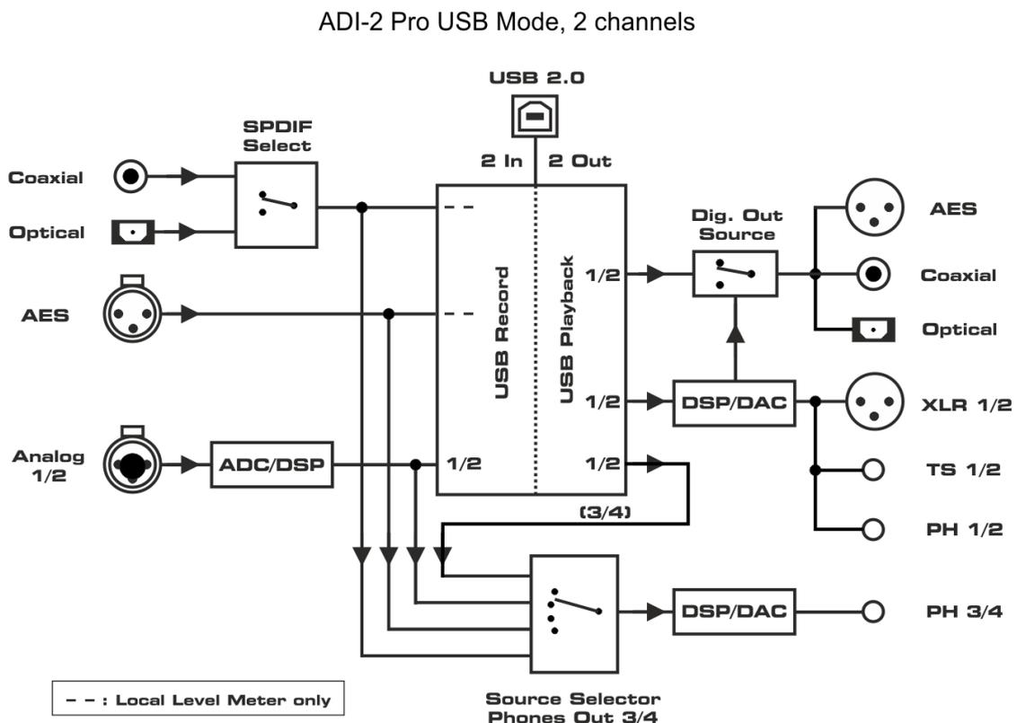
USB Wiedergabekanäle 3/4 können nur im Modus Multi-channel abgehört werden. Im Stereo-Modus wird bei Auswahl von USB 3/4 das Signal der Kanäle 1/2 wiedergegeben.
