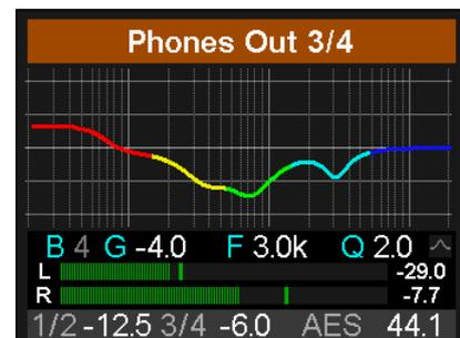
Ein weiterer Druck auf Encoder 2 wechselt zur grafischen EQ Preset Auswahl. Das Drehen von Encoder 2 blättert durch alle vorhandenen Presets, wobei die jeweilige Frequenz-Kurve angezeigt wird, und in der Parameterzeile der Name des Presets erscheint. In diesem Bildschirm sind Volume, die Volume-Auswahl und die Kanalselektion (Encoder 1) ebenfalls verfügbar.
