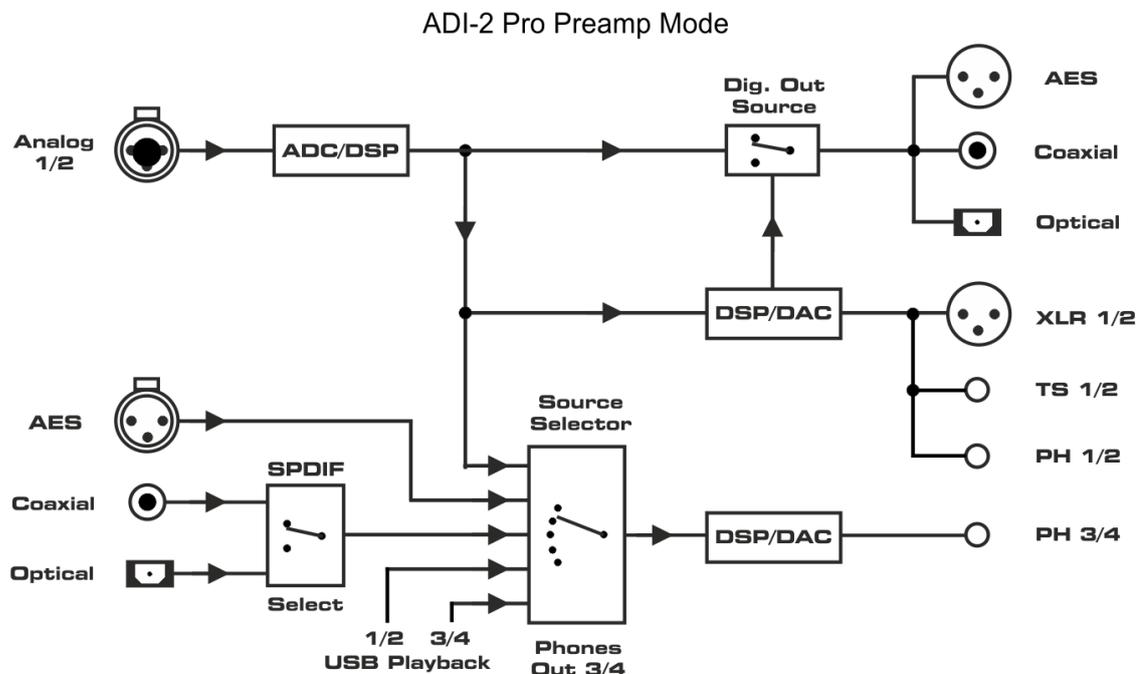
**Hinweis:** Zur Vereinfachung des Diagramms und für eine bessere Übersicht ist USB Aufnahme nicht dargestellt. In allen Modi werden alle Eingangssignale per USB zum Host gesendet. Im Modus Multi-channel drei separate Stereopaare, im Stereo-Modus nur der analoge Stereo-Eingang.
