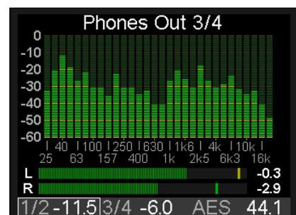
Anders als in den meisten anderen Lösungen wird keine FFT (Fast Fourier Transform) benutzt. RMEs Spectral Analyzer führt eine echte Bandpass-Filterberechnung durch, wie in professioneller Hardware. Der Frequenzabstand zwischen den Filtern entspricht dem menschlichen Hören. Hochoptimierter Code ermöglicht einen 30 Band Analyzer mit 60 dB Anzeigebereich, steilen Filtern und 1 dB Schritten pro Band auf dem DSP des ADI-2 Pro, selbst bei 768 kHz.
