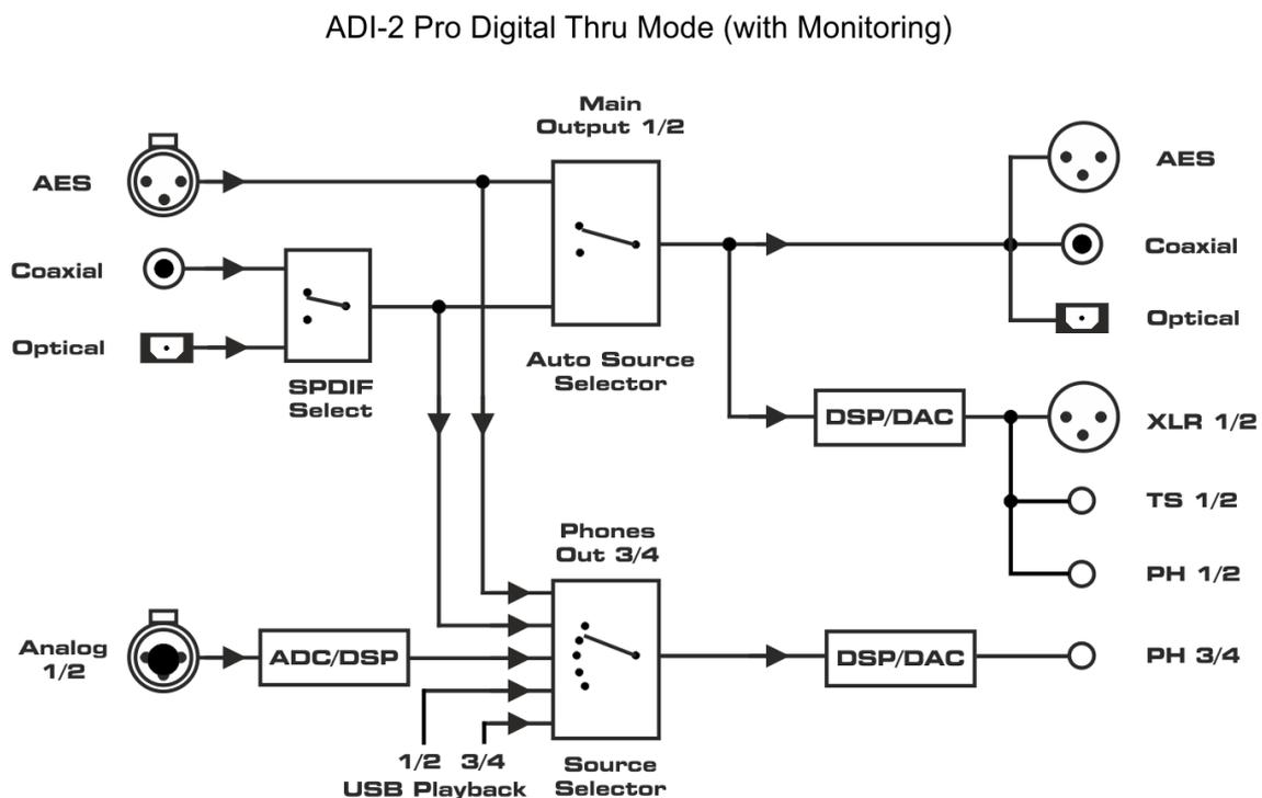
**Hinweis:** Zur Vereinfachung des Diagramms und für eine bessere Übersicht ist USB Aufnahme nicht dargestellt. In allen Modi werden alle Eingangssignale per USB zum Host gesendet. Im Modus Multi-channel drei separate Stereopaare, im Stereo-Modus nur der analoge Stereo-Eingang.
