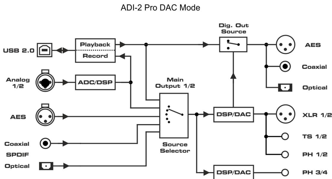
Die Option *Digital Out Source - Main Out* (SETUP – Options – Device Mode / DSD) sendet das prozessierte Signal Main Out 1/2 an die digitalen Ausgänge AES, SPDIF und ADAT, z.B. zum Anschluss aktiver Monitore mit digitalen Eingängen.
