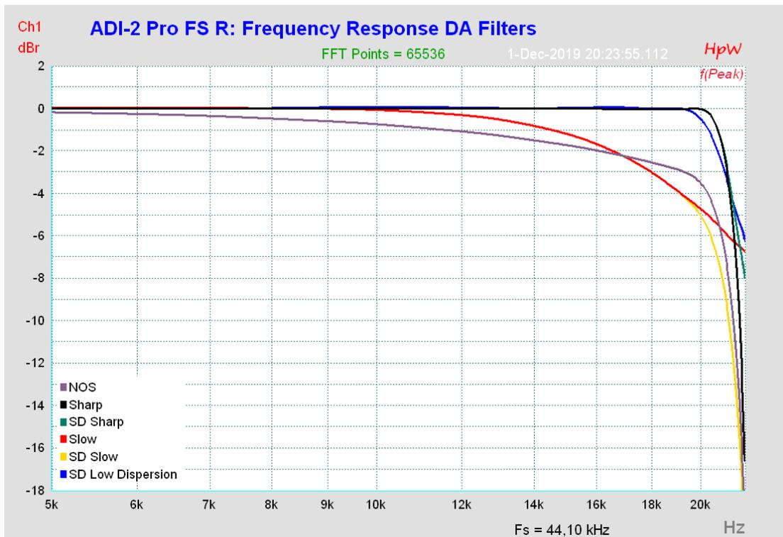
Hinweis: Sharp/SD Sharp und Slow/SD Slow sind praktisch deckungsgleich. NOS weist einen sehr frühen Abfall auf. SD Low Dispersion ist fast so linear wie Sharp/SD Sharp.
