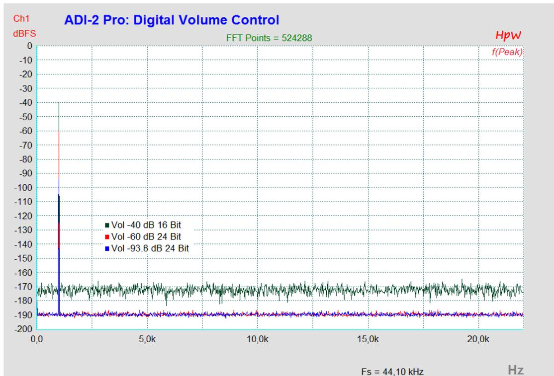
Dies zeigt anschaulich, dass Verzerrungsprodukte der digitalen Lautstärkeinstellung nicht etwa vom Rauschen des DACs übertönt werden, sondern gar nicht erst entstehen. Sie arbeitet selbst mit einem ungeditherten 16 Bit Signal perfekt, es entstehen keinerlei nachweisbare Verzerrungen.
