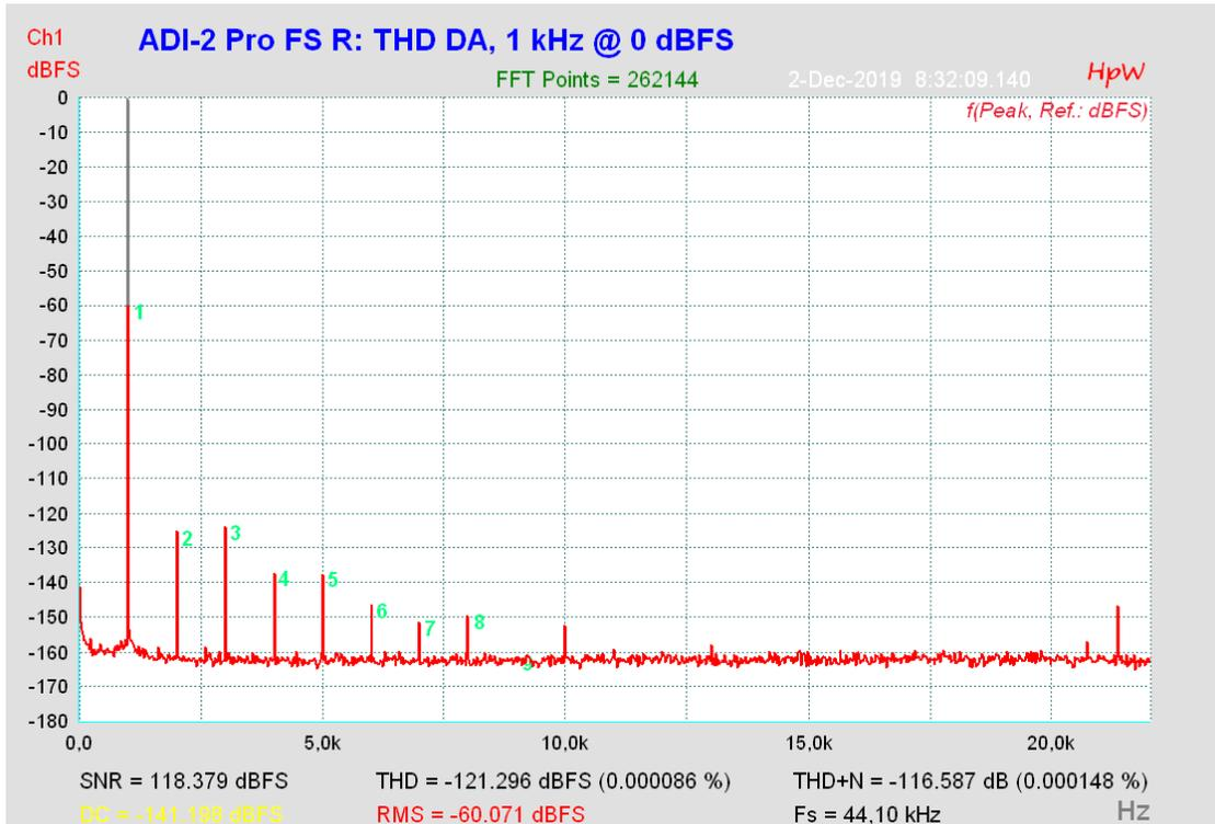
\* Gemessen mit aktivem Notch-Filter über die ADCs des ADI-2 Pro FS im Mono Mode (M/S)
