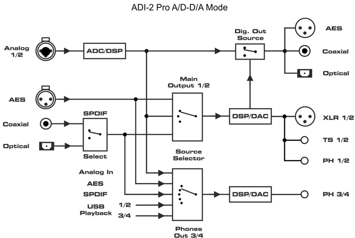
Hinweis: Zur Vereinfachung des Diagramms und für eine bessere Übersicht ist USB Aufnahme nicht dargestellt. In allen Modi werden alle Eingangssignale per USB zum Host gesendet. Im Modus Multi-channel drei separate Stereopaare, im Stereo-Modus nur der analoge Stereo-Eingang.
