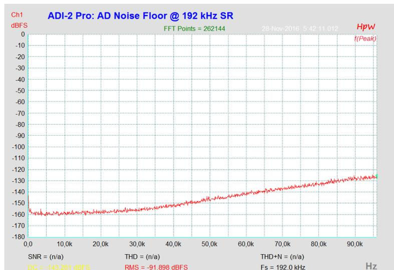
Tatsächlich ist der Rauschanstieg über die Frequenz deutlich niedriger als in früheren Wandlern, wo beispielsweise eine Weitbereichsmessung über 96 kHz nicht -92 dBFS, sondern nur -79 dBFS erreichte.
