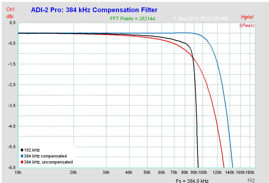
Die blaue Kurve zeigt den Effekt des digitalen Kompensationsfilters bei 384 kHz Samplefrequenz. Der Frequenzgang ist nun bis zu 90 kHz glatt wie ein Lineal, mit keinem sichtbaren Abfall im Bereich des 192 kHz Beispiels. Dank der Kompensation kann der ADI-2 Pro den Frequenzgang jedes mit 192 kHz (oder natürlich auch darunter) betriebenen Geräts perfekt erfassen, mit einer Genauigkeit von Bruchteilen eines dB.
