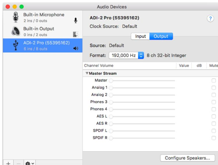
Programme, die keine Karten- und/oder Kanalauswahl unterstützen, verwenden immer den Eingang und Ausgang des unter **Systemeinstellungen - Ton** gewählten Geräts. Diese Einstellung ist auch im Audio MIDI Setup über das Zahnrad unten im Fenster möglich.
