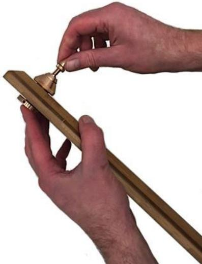
**Schritt 5** Verschrauben Sie die Bolzen mit den Spitzen.
