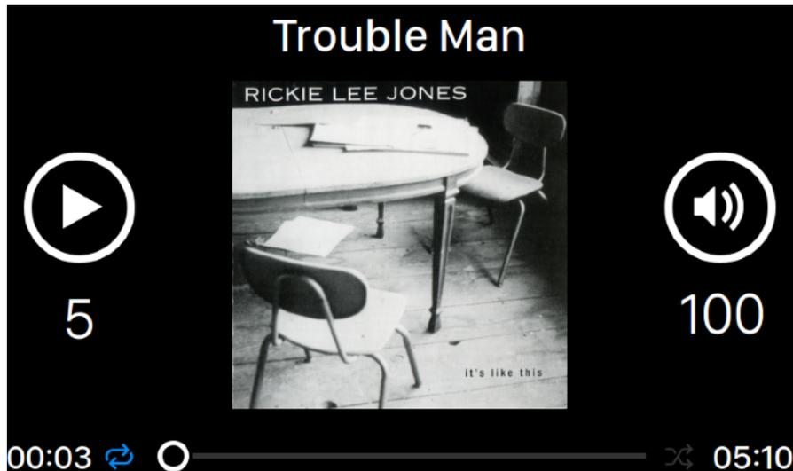
Auf diesem Bildschirm werden der Wiedergabestatus, der Trackfortschritt, der Wiedergabemodus, die Lautstärke und die Metadaten des aktuellen Tracks angezeigt. Drehen Sie den Drehknopf im Uhrzeigersinn oder gegen den Uhrzeigersinn, um die Lautstärke einzustellen, und drücken Sie den Drehknopf, um den Bildschirm "Aktuelle Wiedergabe" zu verlassen.
