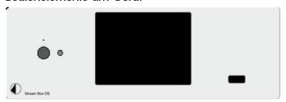
Mit der Taste auf der linken Seite schalten Sie das Gerät ein und bringen es wieder in den Bereitschaftsbetrieb (Stand-By) zurück. Die LED oberhalb der Taste leuchtet blau, wenn das Gerät eingeschaltet ist. Die USB-Buchse rechts hat die gleichen Eigenschaften wie diejenige auf der Geräte-Rückseite. Das Farbdisplay zeigt die Bedienmenüs an. Alle Bedienvorgänge werden mit der Fernbedienung durchgeführt.
