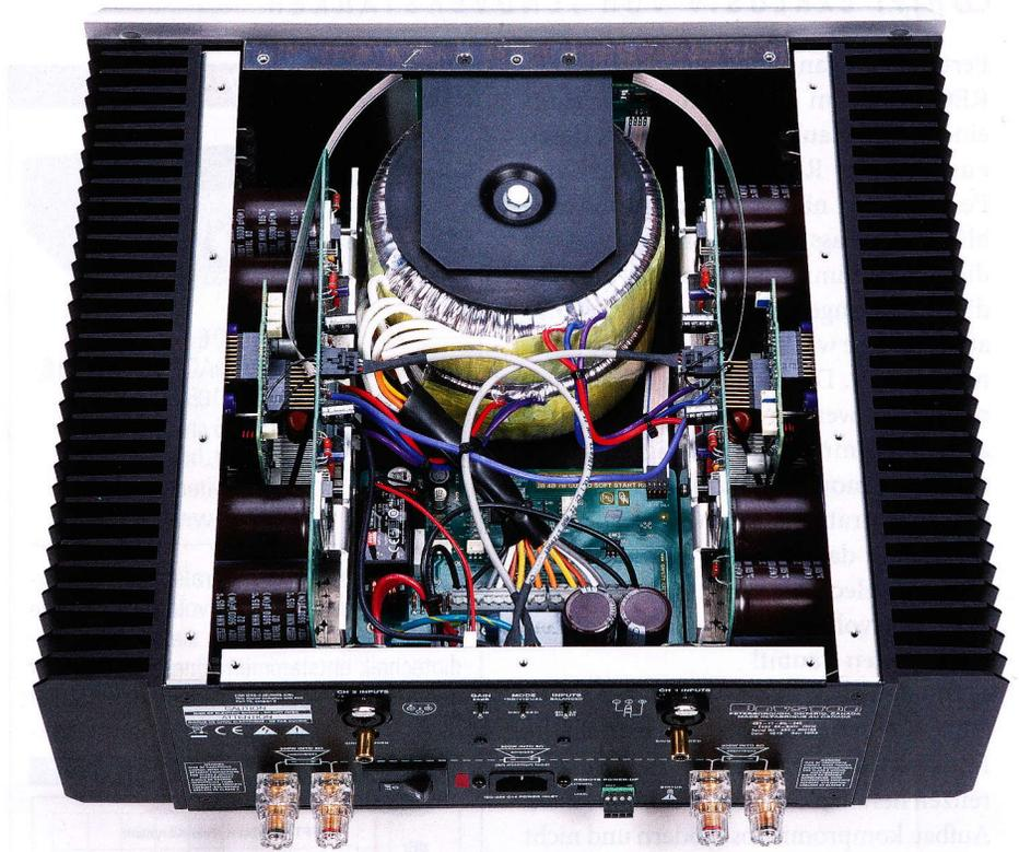
▲ Gleich zwei gestapelte und satt eingespannte Ringkern-Trafos der üppigen Sorte erklären das hohe Gewicht des 4B neuester Generation.
