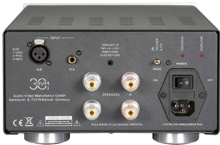
Das Mono-Heck offenbart die Anschlüsse und zeigt die Funktion der Schutzschaltung.
