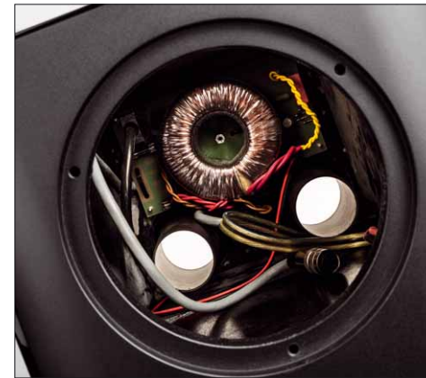
Das ziemlich massive Netzteil für den Hochtöner sitzt innen auf der Rückwand
