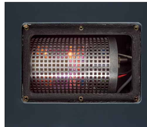
Gut belüftet hinter Gittern sitzt der Hochtöner mit seinem röhrenbestückten Speiseteil
