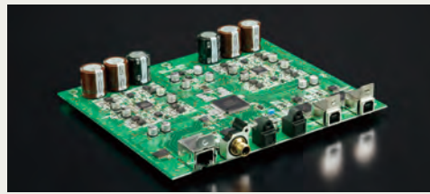
③ D/A-Wandler, mit 8 parallelen Schaltkreisen
