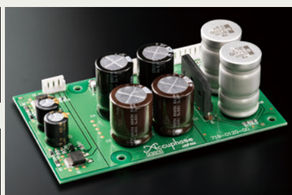
④ Rauscharme Stromversorgungsschaltungen
