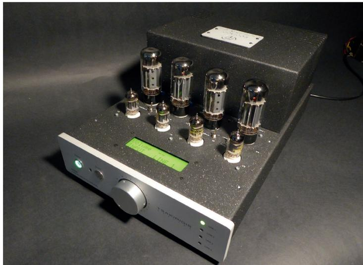
Mit vier klassischen Endröhren des Typs 6CA7 erreicht der Aeolos eine Ausgangsleistung von 2x35W die mittels verlustarmer und breitbandiger Übertrager an den Lautsprecher gekoppelt werden. Im Betrieb kann das Gerät von Ultralinear-Betrieb auf Triodenbetrieb umgeschaltet werden. Die Gegenkopplung kann von „normal“ auf „low“ reduziert werden. So ergeben sich vielfältige Möglichkeiten den Verstärker optimal an die verwendeten Lautsprecher anzupassen.
