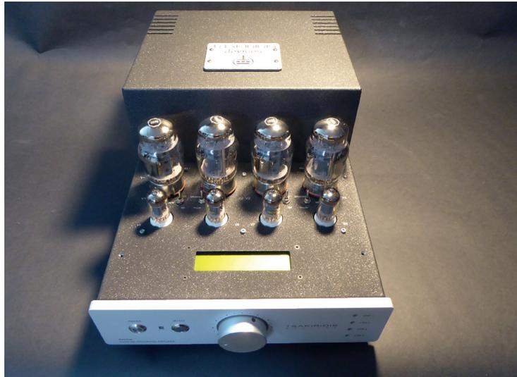
Mit vier klassischen Endröhren des Typs 6550 erreicht der Aeolus Plus eine Ausgangsleistung von 2x45W die mittels verlustarmer und breitbandiger Übertrager an den Lautsprecher gekoppelt werden. Im Betrieb kann das Gerät von Ultralinear-Betrieb auf Triodenbetrieb umgeschaltet werden. Die Gegenkopplung kann von „normal“ auf „low“ reduziert werden. So ergeben sich vielfältige Möglichkeiten den Verstärker optimal an die verwendeten Lautsprecher anzupassen.
