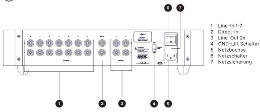
Die Abbildung oben zeigt die Rückansicht des Vorverstärkers zusammen mit einer Beschreibung der Ein- und Ausgänge, die den Anschluss der anderen Elemente Ihres Audiosystems ermöglichen.
