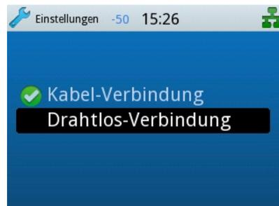
Befand sich die Stream Box RS vorher im drahtgebundenen Netzwerk-Modus, informiert Sie das Gerät nun, dass es zum Wechsel in den WLAN-Modus neu starten muss und fragt Sie, ob Sie das wünschen. Bestätigen Sie mit **OK**. Die Stream Box RS startet nun neu.
