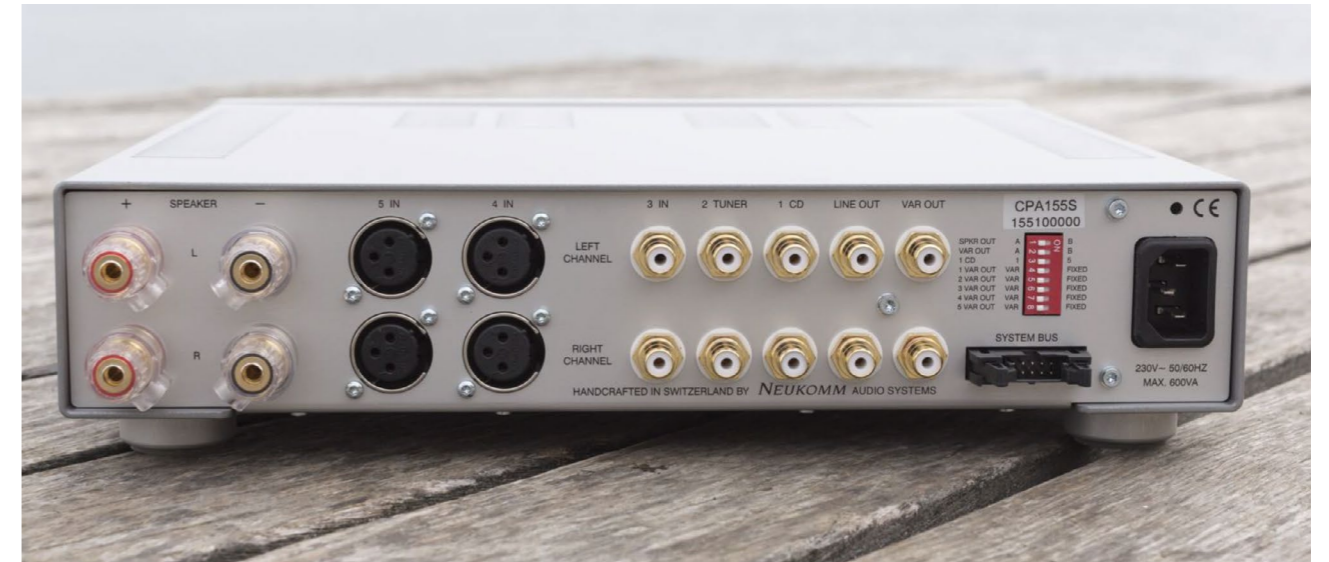
Überlegt bestückt: Dank zweier unabhängiger Line-Ausgänge lässt sich der Neukomm CPA155S in unterschiedlichste Anlagen-Konfigurationen einbinden (Foto: www.ernstlitscher.com )
