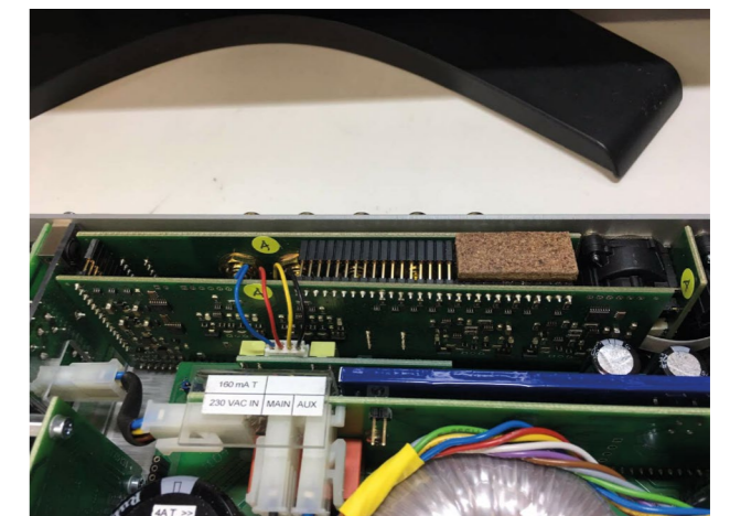
Die Eingangs- und Vorverstärker-Baugruppe ist unmittelbar bei den Anschlüssen an der Rückwand montiert (Foto: J. Schröder)
